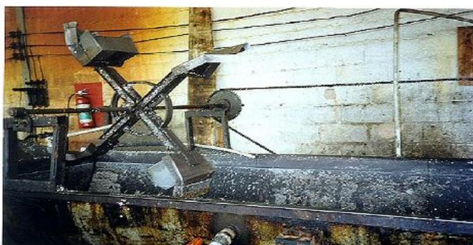
Figura 2 – Equipamento utilizado para lavagem de fragmentos plásticos no processo de reciclagem
